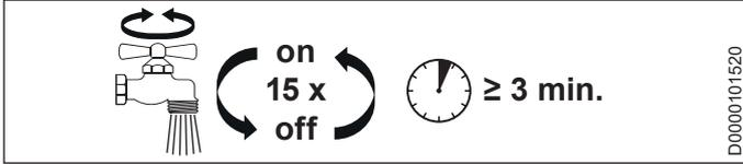
◀ افتح جميع صمامات السحب الموصلة وأغلقها 15 مرة في غضون 3 دقائق بحدٍ أدنى إلى أن تخلو شبكة الأنابيب والجهاز من الهواء. قم بتفريغ الهواء من وصلة الماء البارد والجهاز بتدفق يبلغ 3.5 لتر/دقيقة بحدٍ أدنى.
